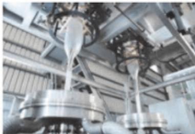
La máquina de película de doble cabezal de POLYSTAR ofrece una alternativa económica y brinda un retorno de la inversión mucho más rápido en comparación con una máquina de película equipada con IBC. Se puede obtener un rendimiento mucho mayor con un tornillo más grande (de 65mm o 75mm de diámetro) incluso al producir un ancho de película más pequeño. Es especialmente efectiva para fabricantes de bolsas planas y camiseta que buscan máquinas menos costosas con rendimientos más altos.
