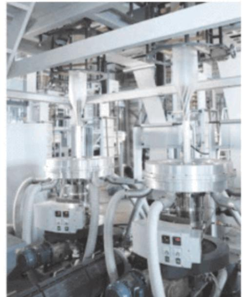
La máquina de película de doble cabezal de POLYSTAR ofrece una alternativa económica y brinda un retorno de la inversión mucho más rápido en comparación con una máquina de película equipada con IBC. Se puede obtener un rendimiento mucho mayor con un tornillo más grande (de 65mm o 75mm de diámetro) incluso al producir un ancho de película más pequeño. Es especialmente efectiva para fabricantes de bolsas planas y camiseta que buscan máquinas menos costosas con rendimientos más altos.
