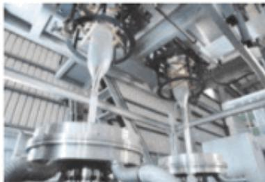
700mm en cada rebobinador. La máquina de película de doble cabezal también permite a los productores cambiar entre HDPE y LDPE al igual que producir diferentes anchos de película en la misma máquina simultáneamente.
