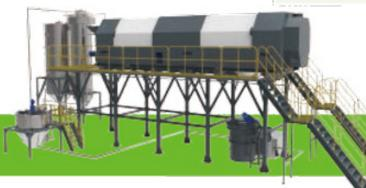
采用连续进料,连续清洗的方式。利用 具有专利及特殊设计的内部结构与蒸汽 加热的高温药剂水清洗瓶体表面,把瓶 子表面的PP标签,纸标签,泥沙,胶 水,橡胶,金属等杂质通过过滤系统去 除,使PET瓶在洗涤机腔体内部彻底洗 净。透过在线传感侦测系统,自动控制 药剂温度及药剂补充,实现生产工艺全 自动控制,保证洗瓶质量。
