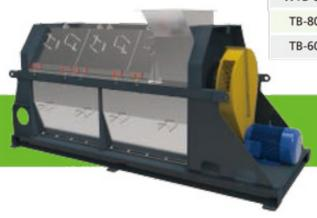
专利设计的脱标机刀片具耐久性长,高效脱标与低损伤瓶体的特性,有更长使用寿命和高速的脱标效率,低损伤瓶体的特性,一般脱标率约在90%以上,破瓶率约在5%以内,正常情况下,使用寿命可长达1000吨。
